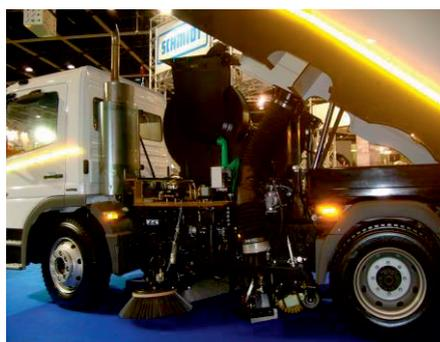
L'impianto di rimozione e raccolta del rifiuto è corredato da un impianto di erogazione di acqua nebulizzata per l'abbattimento delle polveri in corrispondenza delle spazzole e della bocca di carico. Il rifiuto raccolto è immagazzinato all'interno di una vasca chiusa, posta in depressione; alla fine delle operazioni la vasca è svuotata all'interno di appositi contenitori o all'interno di attrezzature di compattazione scarrabili o montate su autotelaio, in sosta presso le stazioni intermedie.
