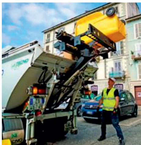
*Gli autocarri leggeri, dotati di cassone ribaltabile di capacità variabile da 4 a 5 m<sup>3</sup>, possono essere attrezzati con una rastrelliera per lo svuotamento meccanizzato di contenitori per rifiuti urbani su ruote di capacità da 120 a 360 litri o con braccio mobile e dispositivo di presa per la raccolta dei rifiuti voluminosi abbandonati a terra.*
